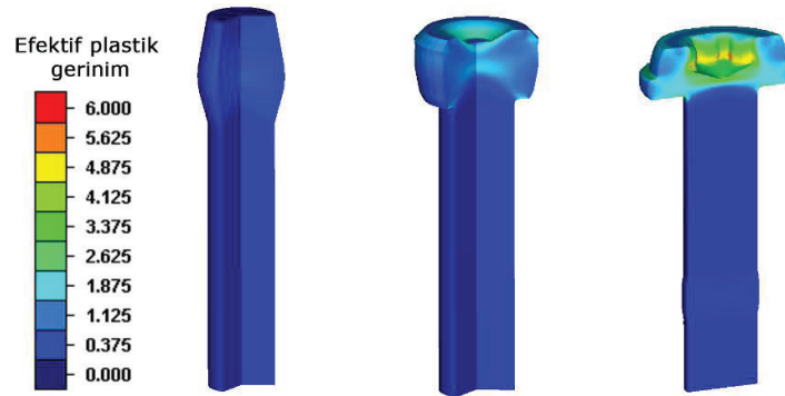
Şekil 6. Her bir istasyonda iş parçası üzerinde meydana gelen efektif plastik gerinim dağılımı.
