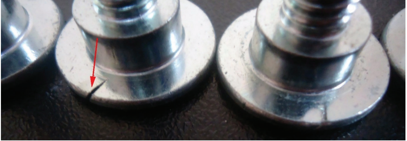
Şekil 1. Bağlantı elemanlarında kafa formunda meydana gelen çatlak hatası
