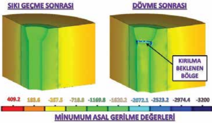
Şekil 11: Kalıplarda oluşan Minimum Asal Gerilmeler
