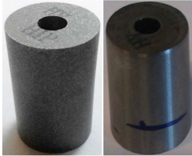
Şekil 1. WC/27Co(G55) Malzemelerin Ham (sol) ve İşlenmiş Formu (sağ)
